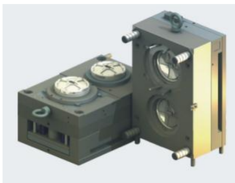
Figura 3: Modelo de Molde de injeção de Aço, 2007.
